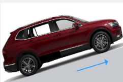
**Prevee que el vehículo se rueda hacia atrás** controlando el torque de inicio para arrancar en superficie inclinada.
